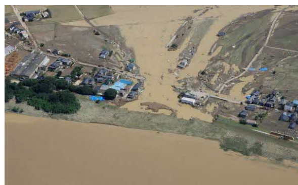
堤防決壊による家屋の流失(鬼怒川)
