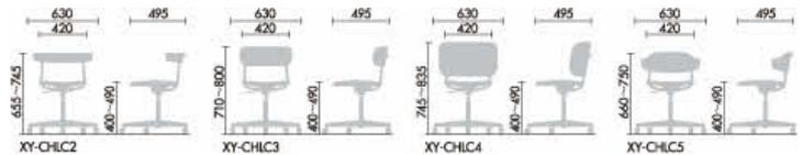
■背…ブナ成型合板 (W2W、W2B)、ホワイトアッシュ突板 (W70、W2G、W73)、ウレタン塗装 ■脚…スチール、粉体塗装 (E6A、2KA) ■張り地…布張地 (アクリル、ウール) ■キャスター…ウレタン巻き ●木質のフローリングのような硬い床でも床に傷をつけにくい「ポリウレタン巻きキャスター」仕様です。 ※クッションフロア上ではご使用にならないでください。床を傷つける場合があります。
