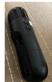
（左）SLAM用スキャナLeica BLK2GO （右）RTK-GNSS計測に用いた Droger RWXのアンテナ受信機部分
