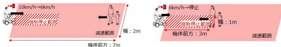
LiDAR活用イメージ図（2段階制動）
