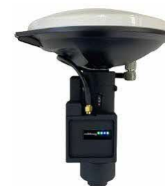
（左）SLAM用スキャナLeica BLK2GO （右）RTK-GNSS計測に用いた Droger RWXのアンテナ受信機部分
