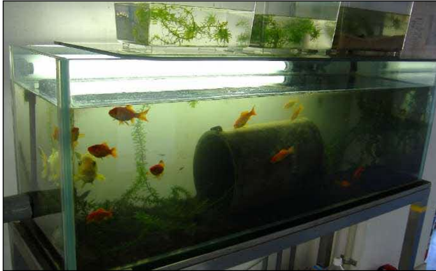
図：金魚による水質異常監視装置
