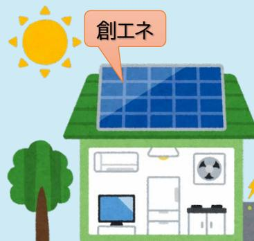
太陽光発電と蓄電池の併用で、日中発電した電力を蓄えておき、夜間に使用することが可能。日中のピークカット効果に加え、停電時に非常用電源としても有用。
