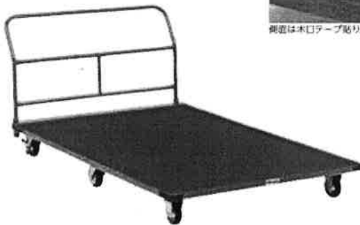
T-1697 マットトラック120×180 ¥114,070(税別¥103,700) [15] ●幅120×長さ180×取手高さ78cm●42kg●主材:ラワンランバー・コア板24mm●キャスター10cm●前輪固定式、中輪自在式、後輪自在式(ストッパー付)●積載容量:300kg●表面カーペット張●コーナー保護ゴム付
