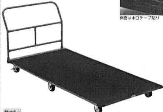
T-1696 マットトラック90×180 ¥103,070(税別¥93,700) [13] ●幅90×長さ180×取手高さ78cm●33kg●主材:ラワンランバー・コア板24mm●キャスター10cm●前輪固定式、中輪自在式、後輪自在式(ストッパー付)●積載容量:300kg●表面カーペット張●コーナー保護ゴム付
