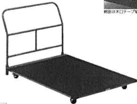
T-1695 マットトラック90×120 ¥84,150(税別¥76,500) [11] ●幅90×長さ120×取手高さ75cm●24kg●主材:ラワンランバー・コア板24mm●キャスター7.5cm●前輪固定式、後輪自在式(ストッパー付)●積載容量:150kg●表面カーペット張●コーナー保護ゴム付
