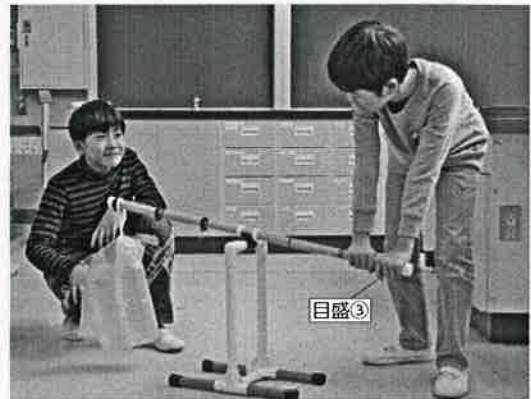
目盛③の位置を持っておもりを持ち上げます。小さい力で持ち上げることが体感できます。
