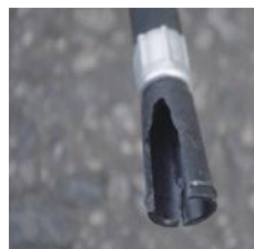
× ノズルの破損
