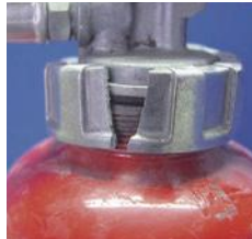
× キャップの破損
