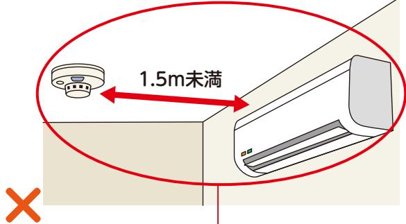
エアコン(空気吹出しき)から1.5m未満の位置に感知器が設置されている
