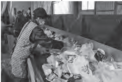
運び込まれたごみをすべてベルトコンベヤーに乗せ、異物や汚れの付着したごみを1つ1つ手で取り除きます
