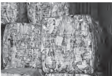
異物を取り除いたプラごみを圧縮して、ブロック(ペール)にします
