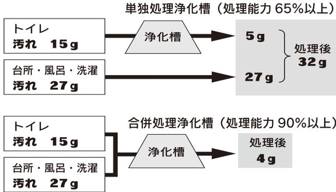
単独処理浄化槽は、合併処理浄化槽と比べて、汚れの排出量が8倍にもなります。
