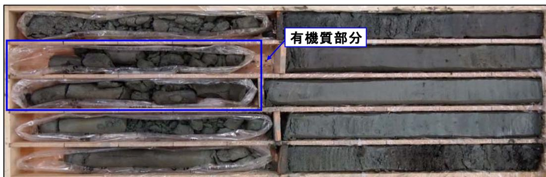
写真5.1.2 No.2孔の「第2洪積粘性土層(Dc2)」[深度15～20m]
