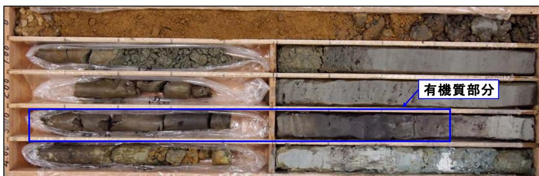
写真5.1.1 No.1孔の「沖積粘性土層(Ac)」[深度0～5m]
