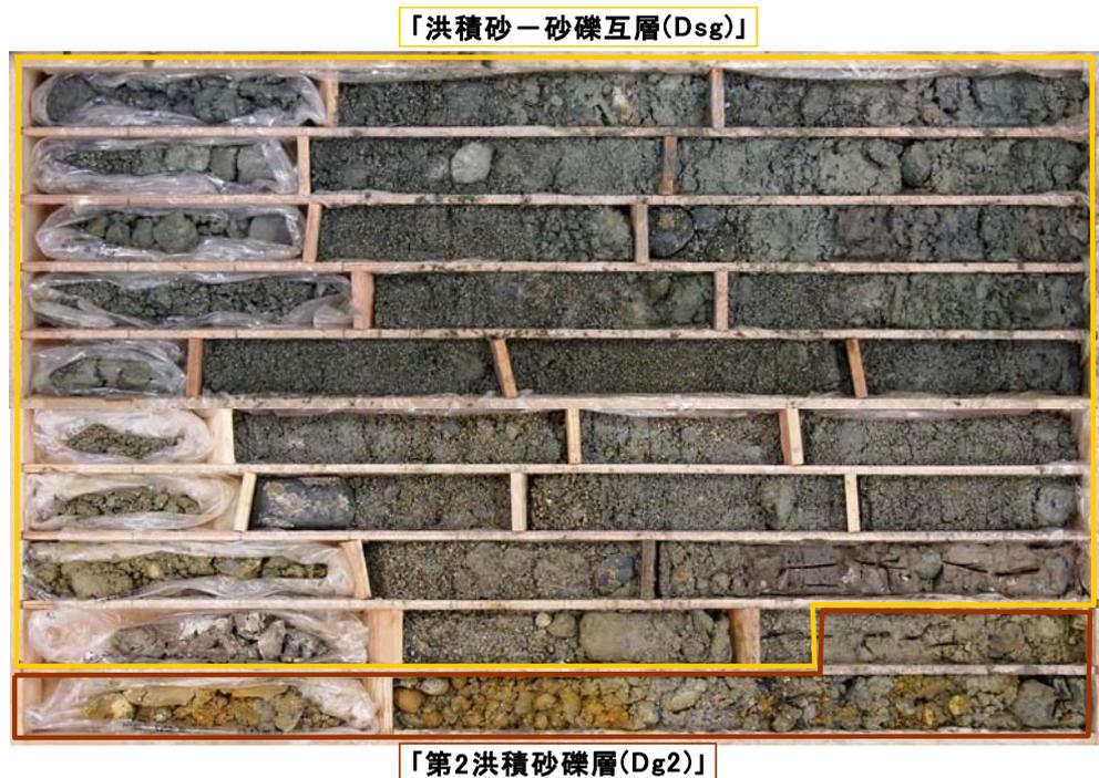
写真5.1.5 No.2孔の「第2洪積砂礫層(Dg2)」[深度25～35m]
