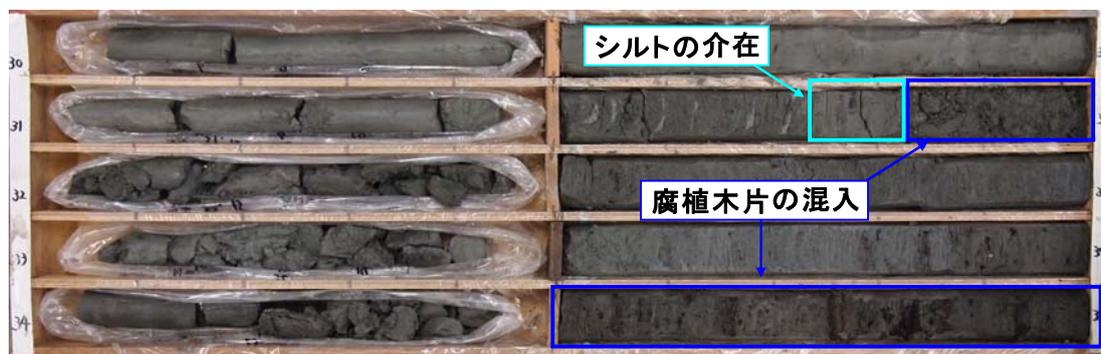
写真5.1.3 No.1孔の「第3洪積砂質土層(Ds3)」[深度30～35m]
